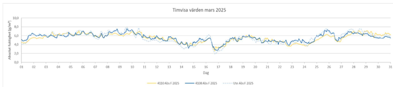
Figur 24 Absolut luftfuktighet i lgh 4108, 4110 och utomhus mars 2025.
